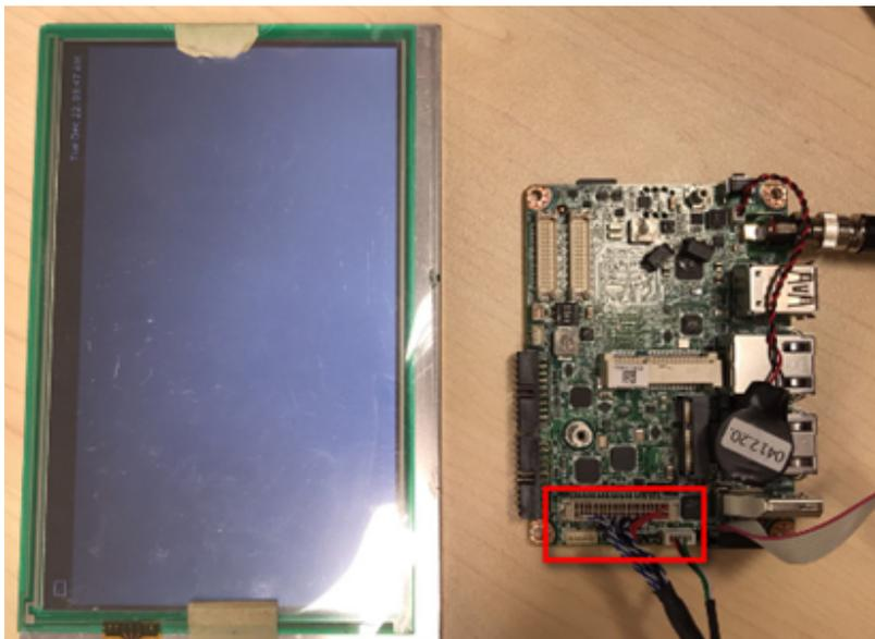
**LVDS1- Panel: G070VW01V0 (VDD: 3.3V, Backlight Power: 12V)**
